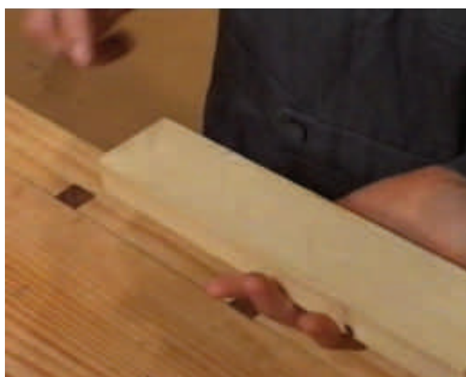
Figura 7: Seleção e referenciação com sinais convencionais da face e do canto da peça
